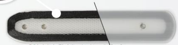
Teilabschnitt der Flügelstütze eines Aeromotion Race Car
